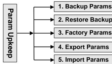
Fig. 6-9 Submenu list of parameter upkeep
